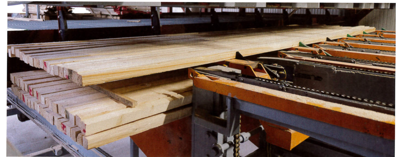
Hier passt jede Lage: Die Stapelanlage von MH Maschinen kommt auch mit schwierig zu bewältigenden Hölzern zurecht. Sie ist mit sieben Doppelmagazinen für Trocken- und Verlustlatten ausgerüstet. Zudem können auch fallende Breiten gestapelt und die Werkstücke millimetergenau gekappt werden
